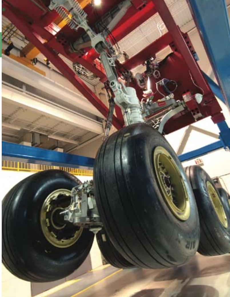
Le système de train d'atterrissage à six roues pèse environ 5443 kg et mesure plus de 7,6 mètres lorsqu'il est totalement déployé.
