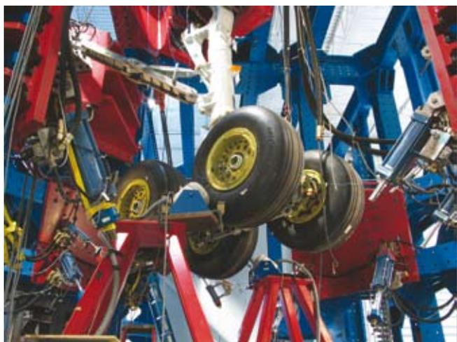
Afin de produire suffisamment d'énergie durant les essais modaux d'un spécimen d'une telle taille, les ingénieurs LMS ont mis en place plusieurs pots vibrants.
