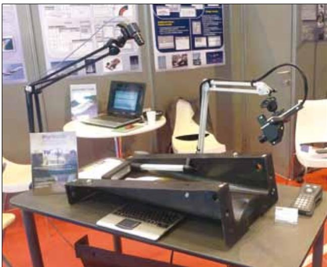
**La dernière version de l'équipement d'aide visuel au placement de plis pour composites PlyMatch d'Anaglyph, avec une meilleure précision et une mesure de la déviation. Leurs clients sont essentiellement en Formule 1, qui recherchent de la précision et acceptent des méthodes de fabrication manuelle innovantes.**
