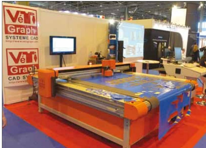
**Chez Vetigraph, l'innovation n'est pas matérielle, avec la même machine présentée de découpe pour les prépregs et les fibre sèches, mais côté logiciel, avec un nouveau module de développé en 2D des modèles 3D, intégré à Graph Cad.**
