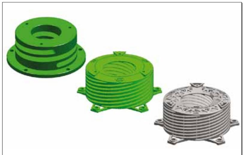
Le ressort original en acier obtenu par usinage de précision à côté des prototypes en titane obtenu par fabrication additive.
