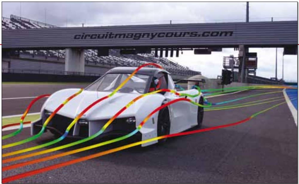
**Aero Concept Engineering a utilisé Open Foam pour concevoir NOAO, le premier véhicule électrique de compétition, avec à la clé la possibilité de lancer de lourds calculs de CFD sur des machines multi-cœurs, sans surcoût.**
