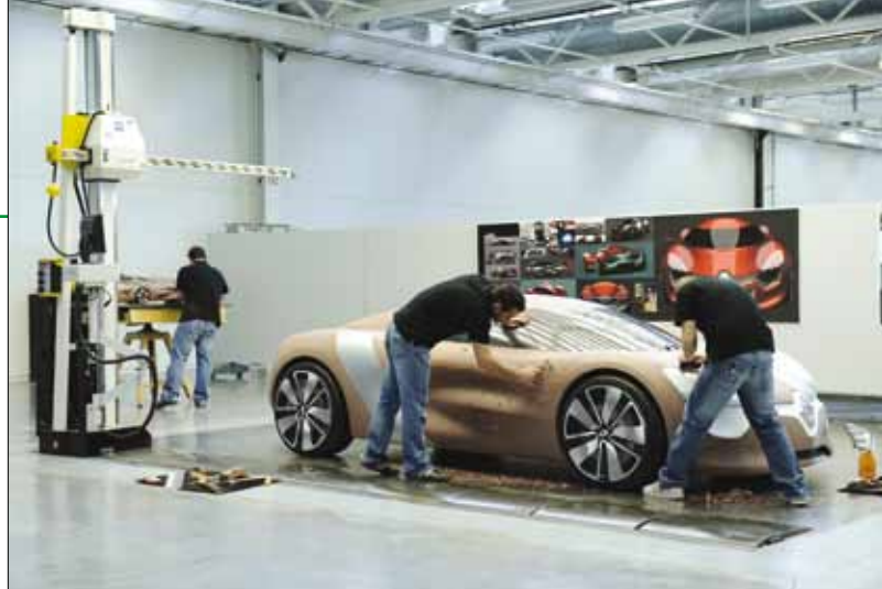
Les maquettes en Clay sont toujours utilisées en parallèle de leurs homologues numériques pour les phases majeures de revues de projet.
