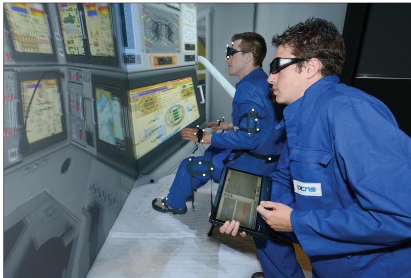
**Le corps et la tête de l'opérateur sont trackés par des caméras infrarouges permettant d'afficher une vue relief calculée en temps réel et en respectant son point de vue. © DCNS**
