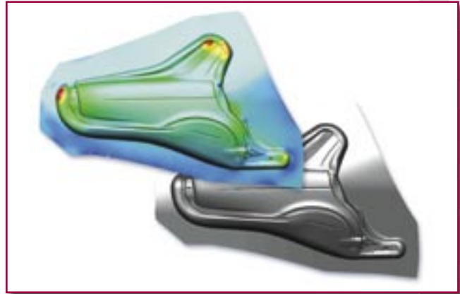
L'emboutissage des tôles comporte des risques de déformation et de rupture dont il n'est pas simple de prévenir à coup sûr l'apparition. (Doc. ESI Group)
