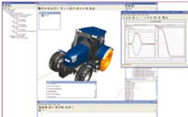
Simpack est utilisé sur un large panel d'applications : de la dynamique véhicule à l'étude vibroacoustique d'un moteur comportant l'ensemble de ses pièces mobiles.
