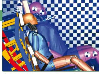
Afin de multiplier les tests virtuels, Simulia propose désormais une copie conforme numérique de Biorid II, le mannequin de choc arrière pour l'automobile.
