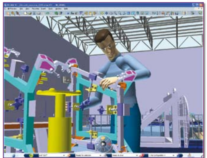
Avec Delmia V6, Dassault système augmente encore la fidélité des simulations faisant intervenir des opérateurs virtuels.
