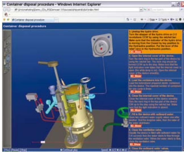
**Avec Cortona3D, 4Dconcept permet de visualiser en 3D des opérations de montage/démontage à l'intérieur de documents XML édités avec Arbortext.**
