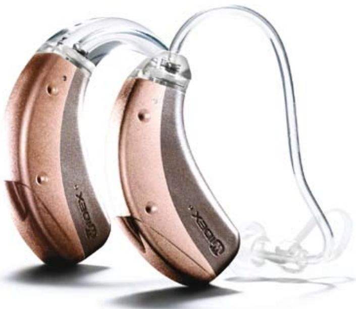
Les prothèses auditives BTE transfèrent le son capté par deux microphones vers l'oreille interne à travers un tube et une terminaison moulée.
