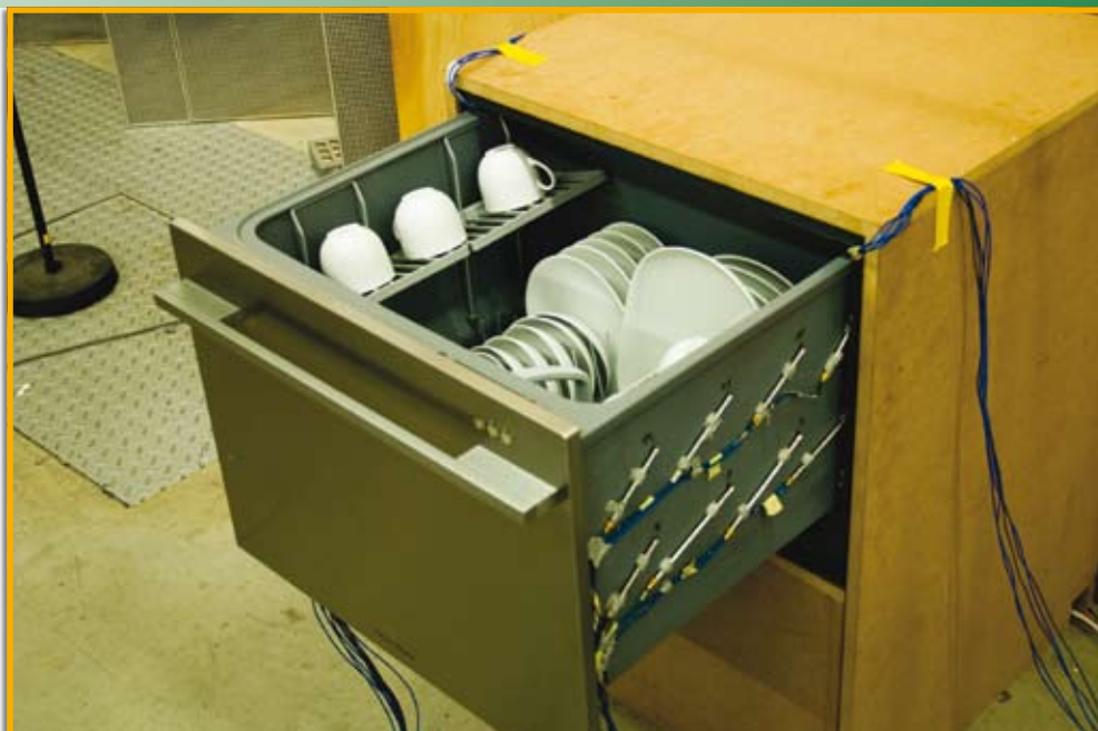
Mesure de la pression acoustique et de la réponse en fréquence du lave-vaisselle réalisée par les ingénieurs de LMS.
