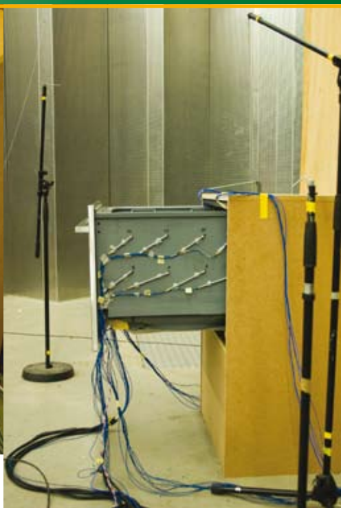
Mesure de la pression acoustique et de la réponse en fréquence du lave-vaisselle réalisée par les ingénieurs de LMS.
