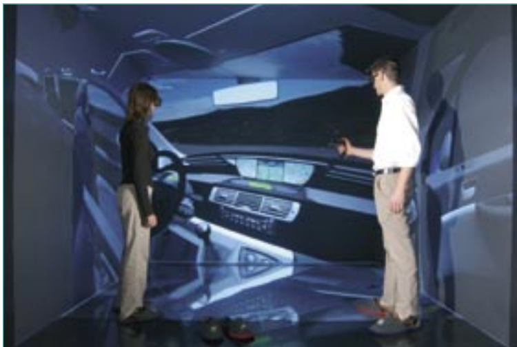
PSA Peugeot Citroën utilise un « Cave » de réalité virtuelle pour vérifier la visibilité depuis le poste de conduite, l'accessibilité aux organes de commande ou encore l'impression de sécurité des passagers. (Doc. PSA)
