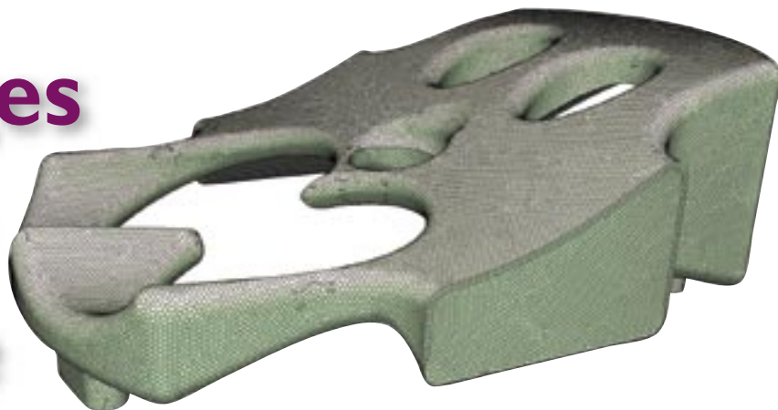
Figure 1 : Aperçu d'un maillage polyédrique pour un calcul d'écoulement au travers d'un circuit de refroidissement moteur.
