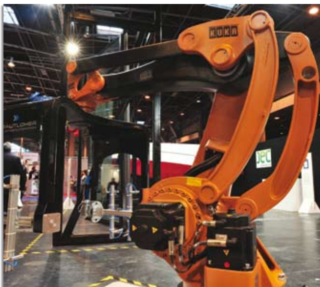
Cellule de soudage robotisée de pièces composites réalisée par Kuka.
