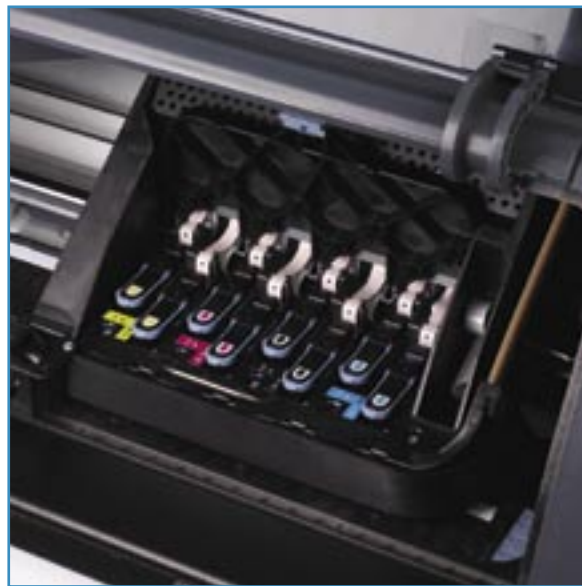
Sur certaines imprimantes comme la 4000 d'HP, il est possible de remplacer les cartouches d'encre sans stopper la machine.
