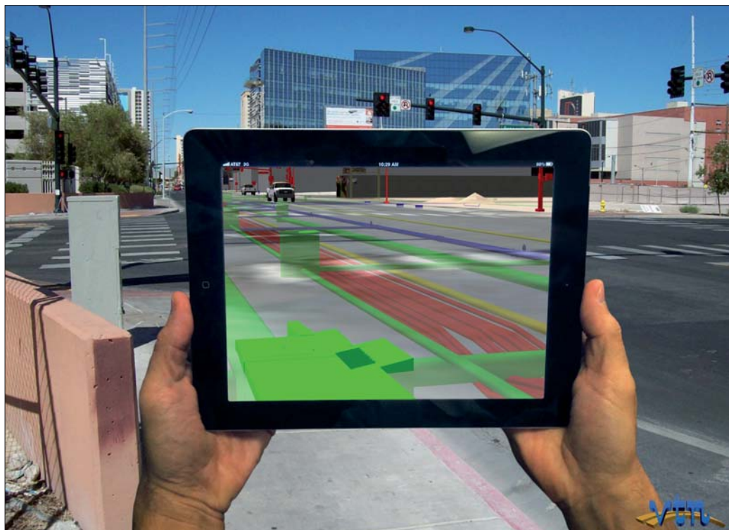
Utilisation de la réalité augmentée à Las Vegas pour découvrir les réseaux de fluides présents sous la chaussée. Courtesy of VTN Consulting.
