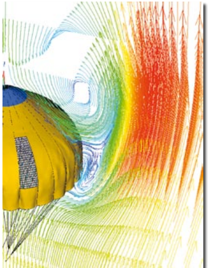
Irvin Aerospace, société basée en Californie, conçoit et produit des parachutes aux applications diverses (militaires, civiles). Fondée sur du matériel SGI Altix, la simulation couple la CFD avec de l'analyse aux éléments finis pour aboutir à de la FSI (Fluid Structure Interaction).
