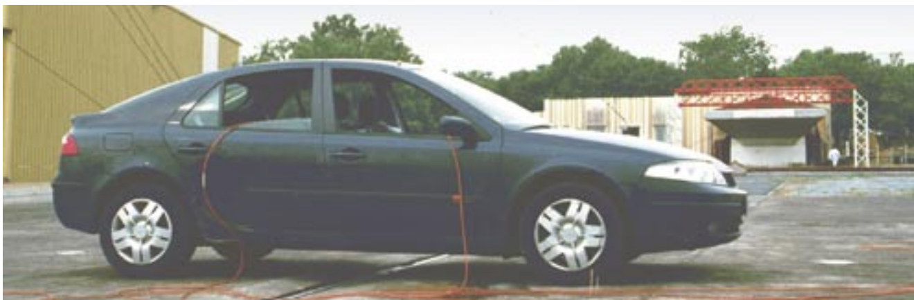
Laguna II sous le simulateur d'impulsions électromagnétiques de Gramat.
