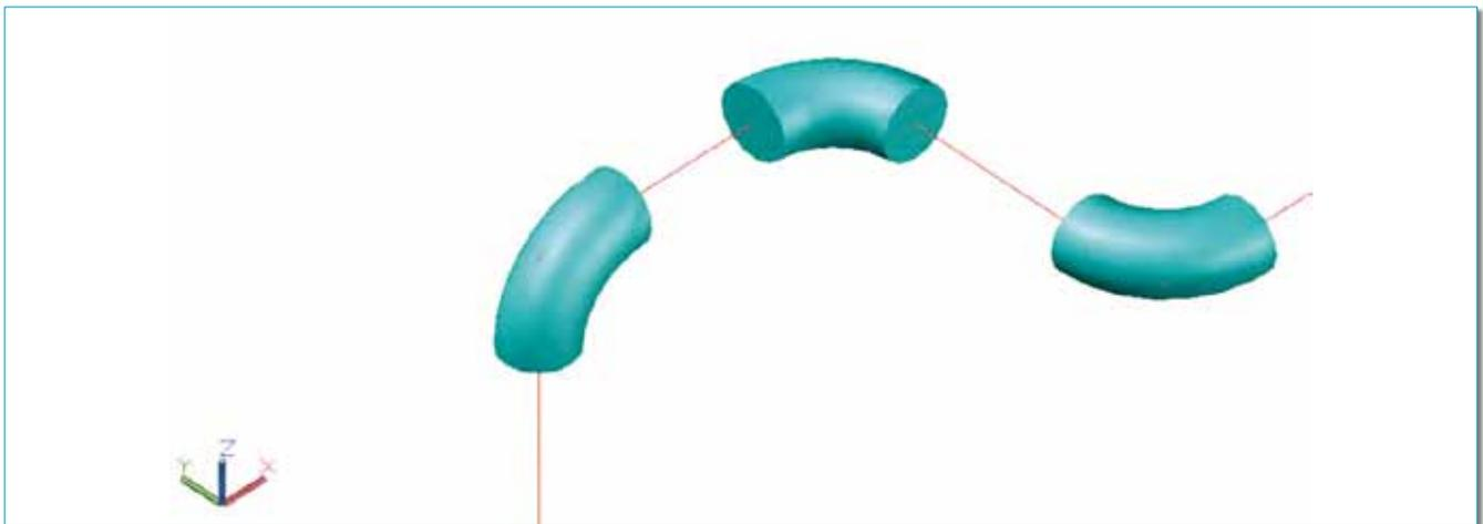
En terme de bloc dynamique, AutoCAD ne sait, pour l'instant, que gérer des actions sur le plan XY. De ce fait, pour pouvoir manipuler des blocs 3D avec des actions dirigées sur les 3 plans : XY, YZ et XZ, il faudra user de quelques astuces.
