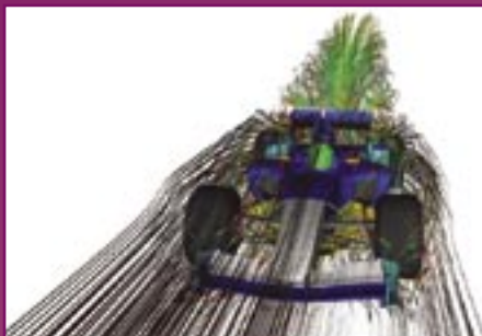
Simulation CFD de l'aérodynamique de la F1 Sauber avec Fluent, montrant les contours de pression et les lignes de courant de la voiture en configuration de course
