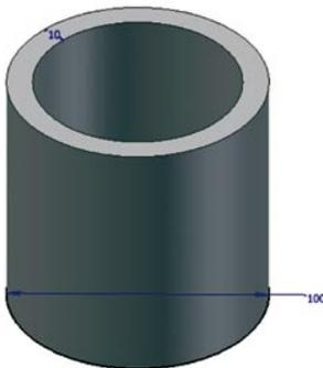
3. Créer un plan de construction tangent au diamètre.
