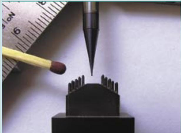
de fraisage, d'une qualité et d'une précision, que les logiciels de FAO traditionnels ne peuvent approcher. Cimatron E Micro-Milling offre une très grande précision de fraisage (de l'ordre du micron), des tolérances machines très serrées, la gestion CAO des imperfections des modèles importés et des parcours d'outils en 3 et 5 axes continus. ▣
