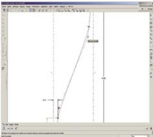
Cette loi qui est utilisée pour contrôler l'esquisse du balayage varie de 0 à 1 sur l'axe des abscisses : 0 correspond au début de la trajectoire du balayage et 1 à sa fin. Sur l'axe des ordonnées la variation se fait de 0 à NBRE\_SPIRE.
