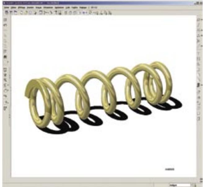
**Note :** Pour une extrémité de ressort différente, il suffit de retravailler légèrement la surface trajectoire pour y ajouter la géométrie des extrémités.
