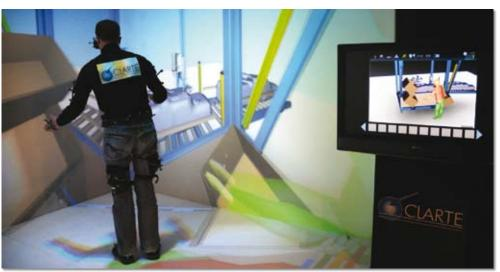
Dans le SAS<sup>3</sup>, l'opérateur est équipé de billes réfléchissantes afin de mesurer sa position en temps réel dans l'espace.
