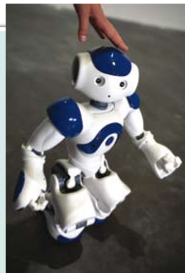
Le petit robot Nao de Aldebaran constitue la plateforme matérielle du projet (Photo Aldebaran)
